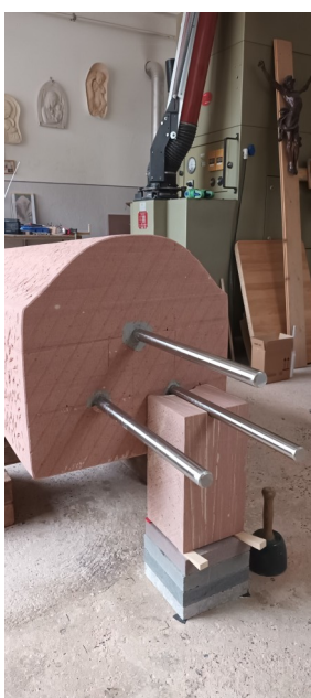
Die gut 80 cm langen Dübel wurden mit Langbohrern zur Hälfte in den Kreuzestamm getrieben. Mittels Spezialmörtel wurden die Dübel fixiert und die drei Teile, aus denen das Kreuz besteht, miteinander verbunden.
