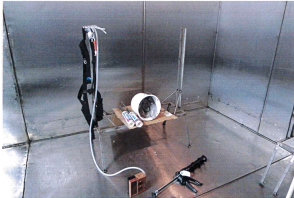
Abb. 2: Nach Abschluss der Extrusion läuft die stationäre Probenahme (eingekreist) über weitere 15 Minuten.
