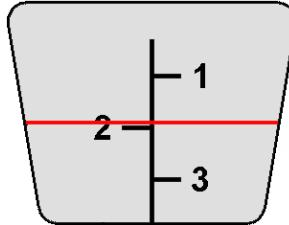
Nachkommastellen können mit der Skala (5) am Griffende in Schritten 0,1 Nm eingestellt werden.
