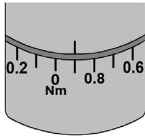
Para nuestro ejemplo de 1,9 Nm, la línea del valor 2 debe estar delante de la línea roja en la ventana de visualización y las divisiones de 0,9 Nm en la marca de referencia.
