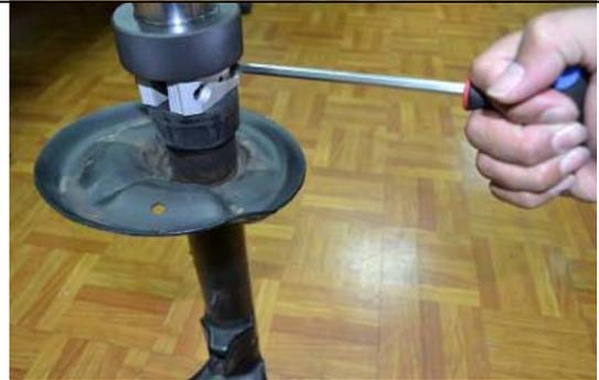
Die Ziehvorrichtung entfernen und Feder und Federteller montieren.
