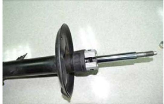
Die Ziehvorrichtung auf das Federbein setzen und die Mutter festziehen.
