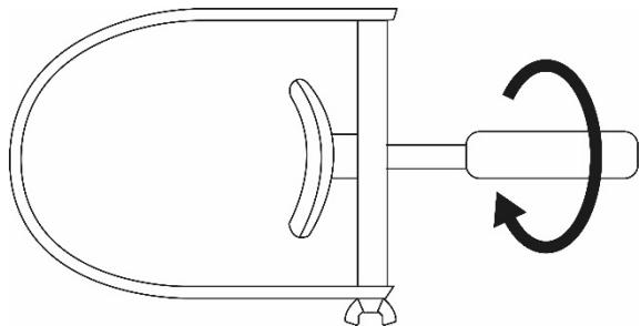
Placer la clé de maintien le plus loin possible sur la roue polaire.
