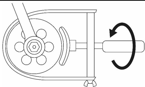
Coloque la llave apropiada en la tuerca del volante y gírela en la dirección de aflojamiento, mientras mantiene la llave de contra-sujeción en su lugar con la otra mano.
