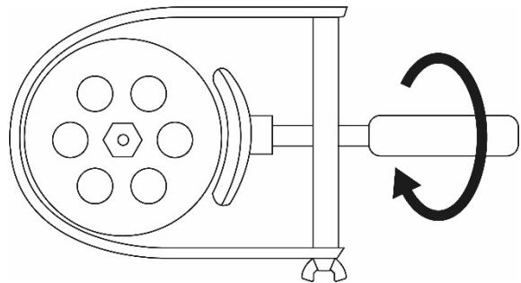
Bloquee la llave de sujeción del contador en la rueda polar girando el dispositivo de sujeción en el sentido de las agujas del reloj.
