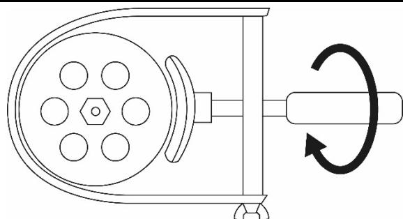
Gegenhalteschlüssel, durch Drehen der Spanneinrichtung im Uhrzeigersinn, auf dem Polrad arretieren.
