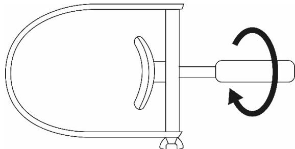
Über die Einstellbohrungen kann der Durchmesser zusätzlich vergrößert bzw. verkleinert werden.
