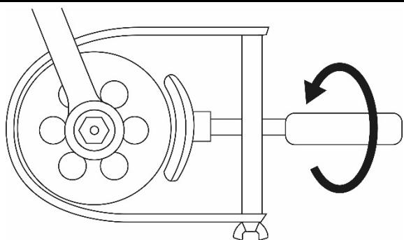
Placer la clé appropriée sur l'écrou du volant moteur et la tourner dans le sens du desserrage, tout en maintenant la clé de maintien en place avec l'autre main.
