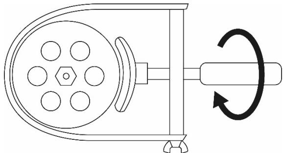
Verrouillez la clé de maintien sur la roue polaire en tournant le dispositif de serrage dans le sens des aiguilles d'une montre.
