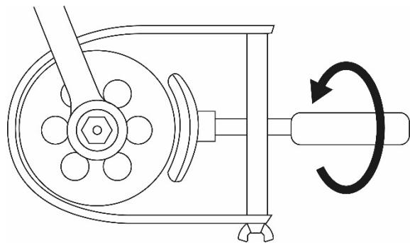
Passenden Schlüssel auf die Polradmutter stecken und in Löserichtung drehen, dabei den Gegenhalteschlüssel mit der anderen Hand fixieren.
