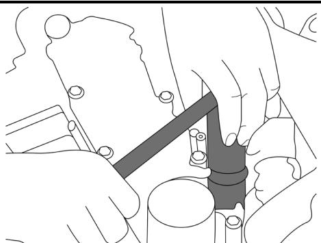
Kleeblattförmige Scheibe herunterdrücken und Halteclip demontieren.
