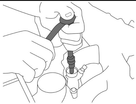
Afloje y retire la tapa de las válvulas.
