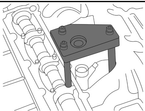
Zugspindel durch die Brücke in den Injektor schrauben.
