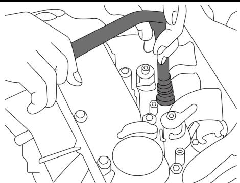
Démonter l'électroaimant de l'injecteur.
