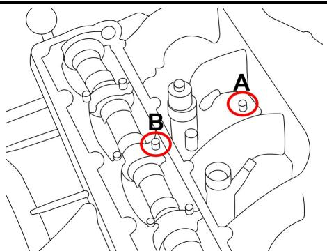
Coloque los pernos de soporte en los agujeros de los pernos del colector de admisión y de la tapa de cojinetes como se muestra en la ilustración.
