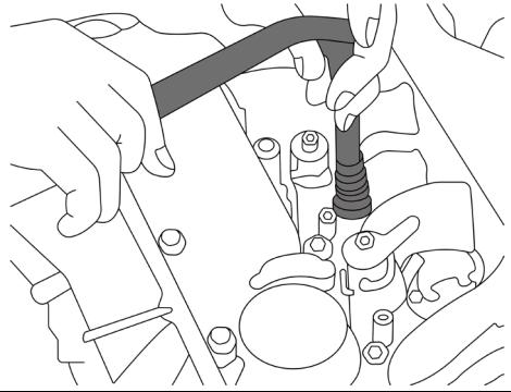
Desmonte el electroimán del inyector.
