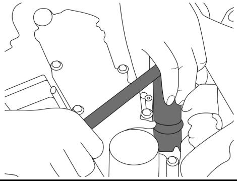
Presione hacia abajo el disco en forma de trébol y retire el clip de retención.
