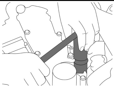
Pousser vers le bas le disque en forme de trèfle et démonter le clip de retenue.
