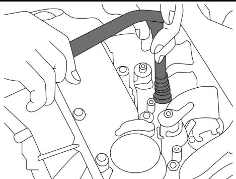
Elektromagnet vom Injektor demontieren.
