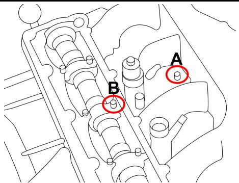
Stützbolzen, wie in der Abb. zu sehen, in die Bohrungen der Ansaugkrümmer- und Lagerdeckelschraube aufsetzen.
