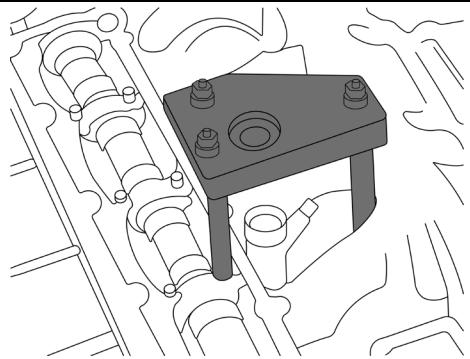
Atornille el husillo de tracción a través del puente en el inyector.
