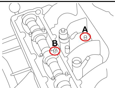
Placer le boulon de support comme le montre l'illustration dans les perçages des vis du collecteur d'aspiration et du couvercle du roulement.
