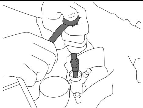
Desserrer et démonter le couvercle de la soupape.
