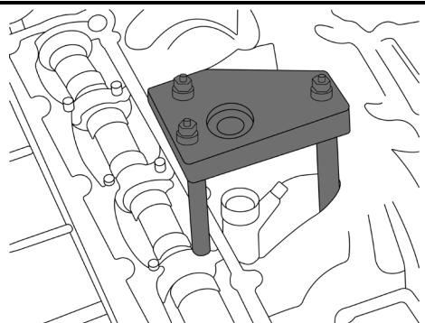
Visser la broche de traction à travers le pont dans l'injecteur.
