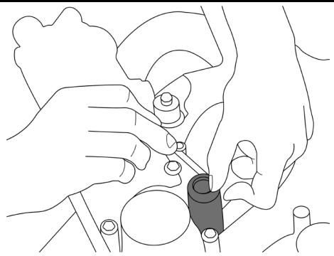
Desserrer l'écrou à œillet avec l'insert six pans femelle et le retirer.
