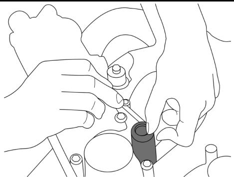
Ringmutter mit Innensechskant-Einsatz lösen und entnehmen.
