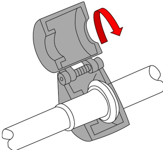
El resorte de retención (B) sirve para asegurar y mantener juntas ambas líneas. Esto debe ser extendido para el desmontaje.
