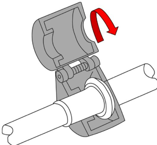
Die Haltefeder (B) dient zur Sicherung und hält beide Leitungen zusammen. Diese muss zur Demontage gespreizt werden.
