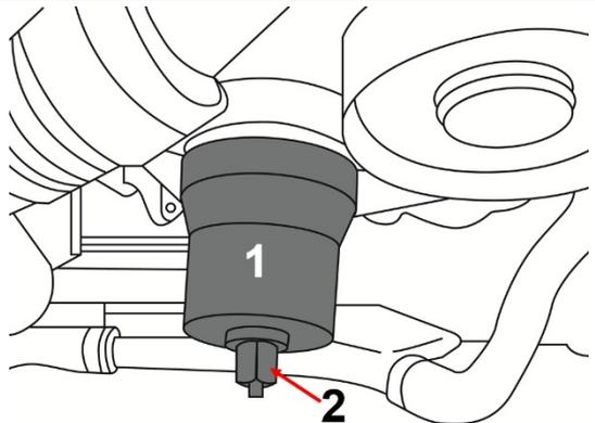
Girando la tuerca (2) se presiona el retén radial del cigüeñal sobre el manguito de empuje (1) hacia el cárter.
