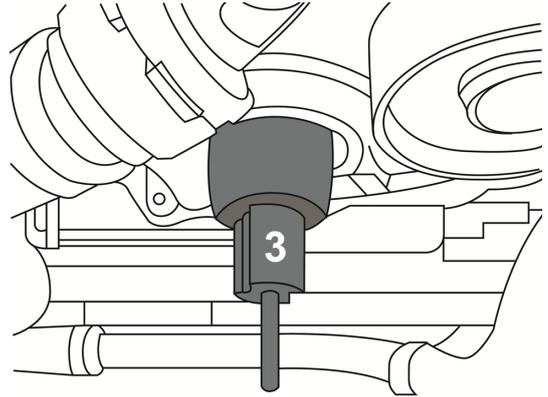
Schieben Sie den neuen Kurbelwellen-Radialdichtring (A) vorsichtig und gerade mit einer Drehbewegung auf das Zentrierwerkzeug (3), bis der Dichtring bündig mit dem Kurbelgehäuse abschließt.
