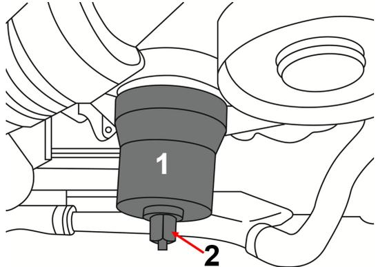
Durch Drehen der Mutter (2) wird der Kurbelwellen-Radialdichtring über die Schubhülse (1) in das Kurbelgehäuse gedrückt.
