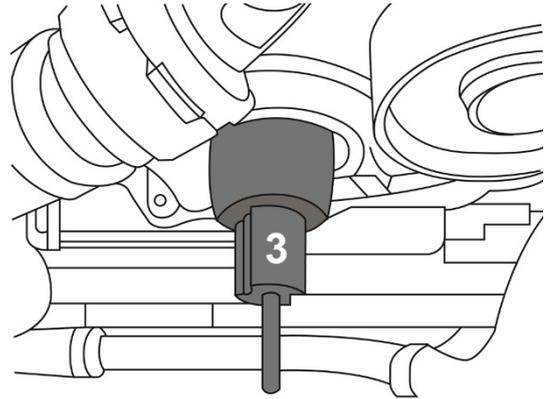
Poussez avec précaution le nouveau joint radial de vilebrequin (A) directement sur l'outil de centrage (3) avec un mouvement de rotation jusqu'à ce que le joint soit au même niveau que le carter de vilebrequin.
