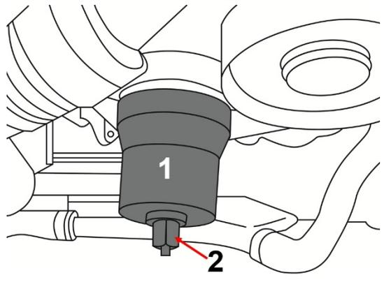
En tournant l'écrou (2), le joint d'étanchéité radial du vilebrequin est pressé dans le carter par l'intermédiaire du manchon de poussée (1).
