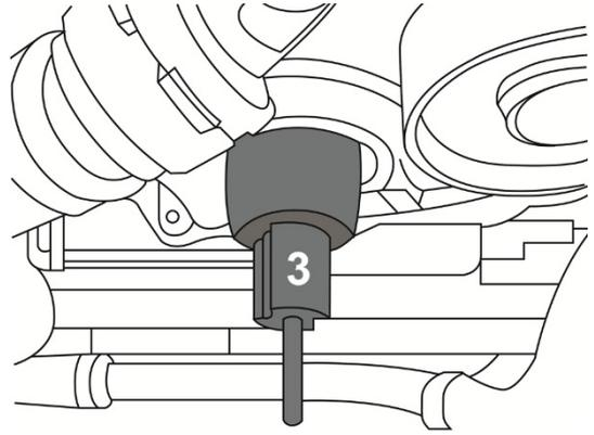
Deslice con cuidado el nuevo retén radial del cigüeñal (A) directamente sobre la herramienta de centrado (3) con un movimiento de giro hasta que el retén quede a ras con el cárter.
