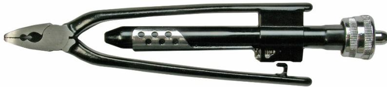
Die Draht-Drehzange wurde konstruiert zwei Drähte, wie z.B. in der Schraubensicherung üblich, zu verdrillen. Die Draht-Drehzange ermöglicht eine leichte, gleichmäßige Verdrillung und erlaubt dadurch eine exakte Schraubensicherung.
