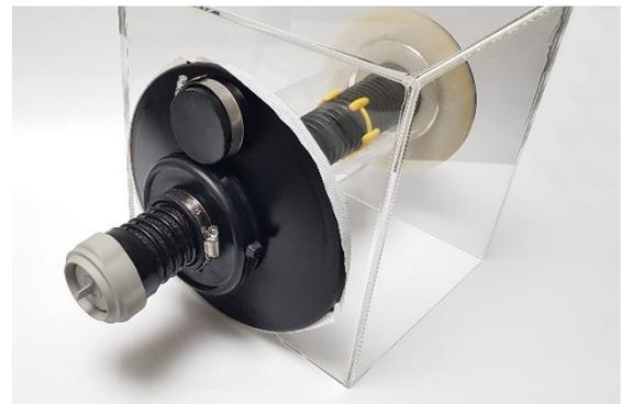
*Info: Bei Vorhandensein einer Gebäudeabdichtung nach DIN18533 muss der Dichtflansch 18533 auf der Bestandsabdichtung anliegen. Hierzu müssen ggf. Noppenbahn, Gleitfolie und Dämmung im Bereich um die Kernbohrung entfernt werden, um die Gebäudeabdichtung freizulegen!*
