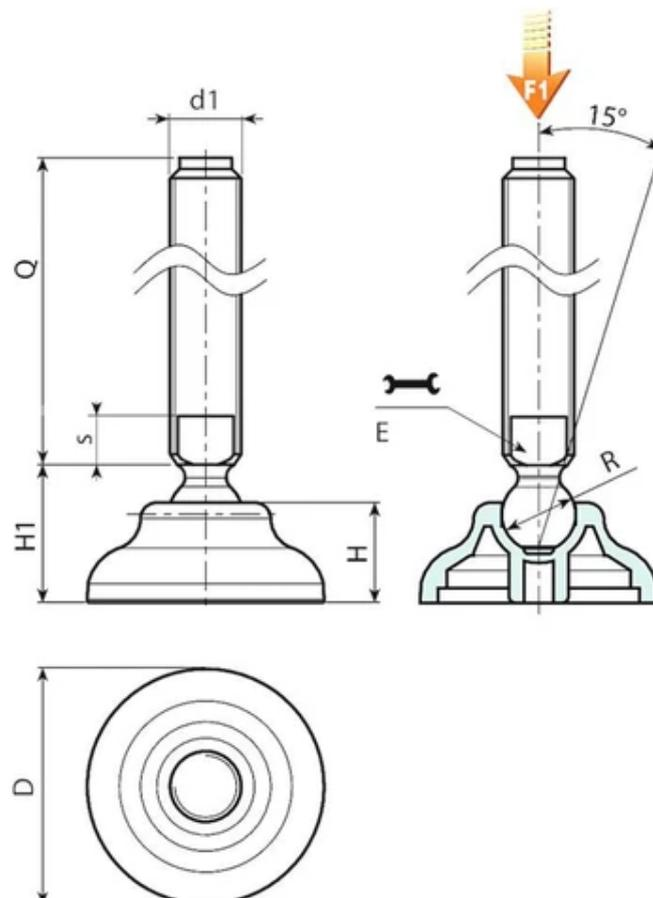
**Version P907 : Pied d'appui avec tige de type B (logement pour clé fraisé) et bille 15**
