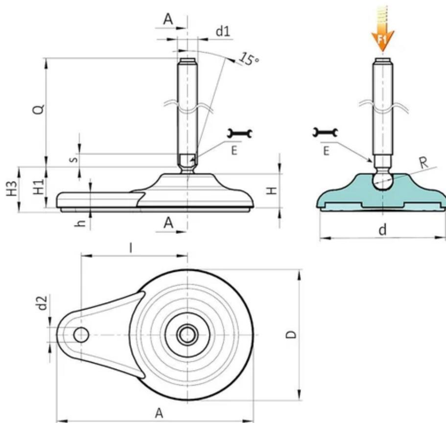
**Version P705 : Pied d'appui avec fixation latérale, tige de type B (logement pour clé fraisé), bille 12,5 et base antidérapante en SBS**
