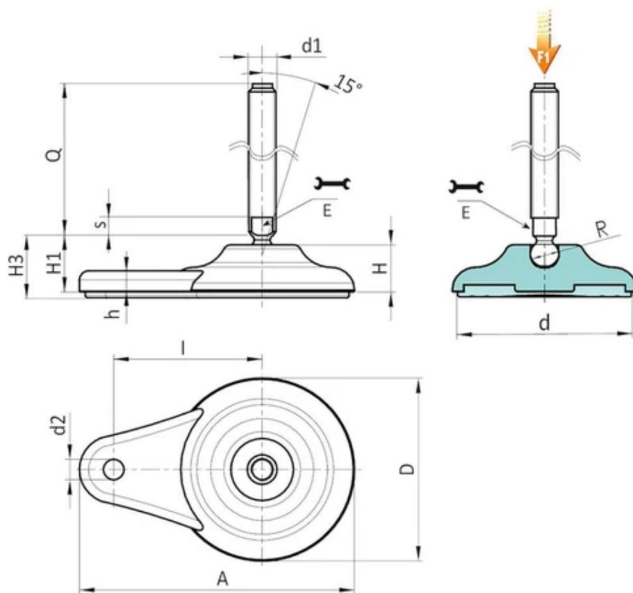
**Version P709 : Pied d'appui avec fixation latérale, tige de type B (logement pour clé fraisé), bille 24 et base antidérapante en SBS**
