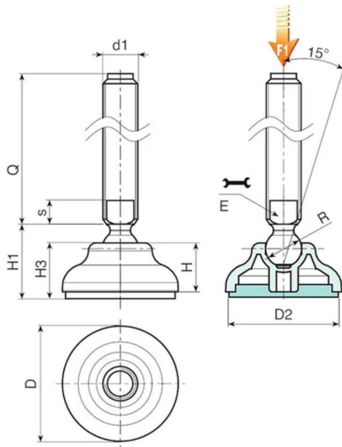
**Version P909 : Pied d'appui avec tige de type B (logement pour clé fraisé) et bille 12,4 avec base antidérapante en SBS**
