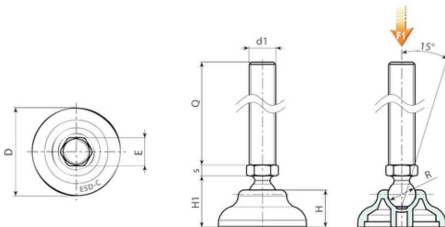
**Version P905ESD: Pied d'appui avec tige de type A (avec hexagone) et bille 15**
