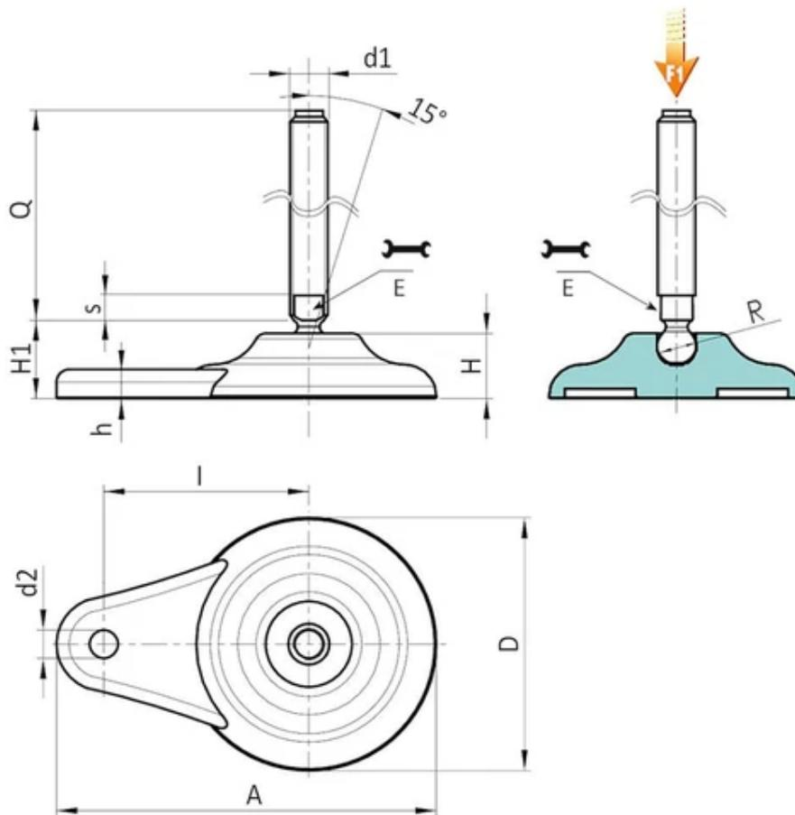
**Version P706 : Pied d'appui avec fixation latérale, tige de type B (logement pour clé fraisé) et bille 15**
