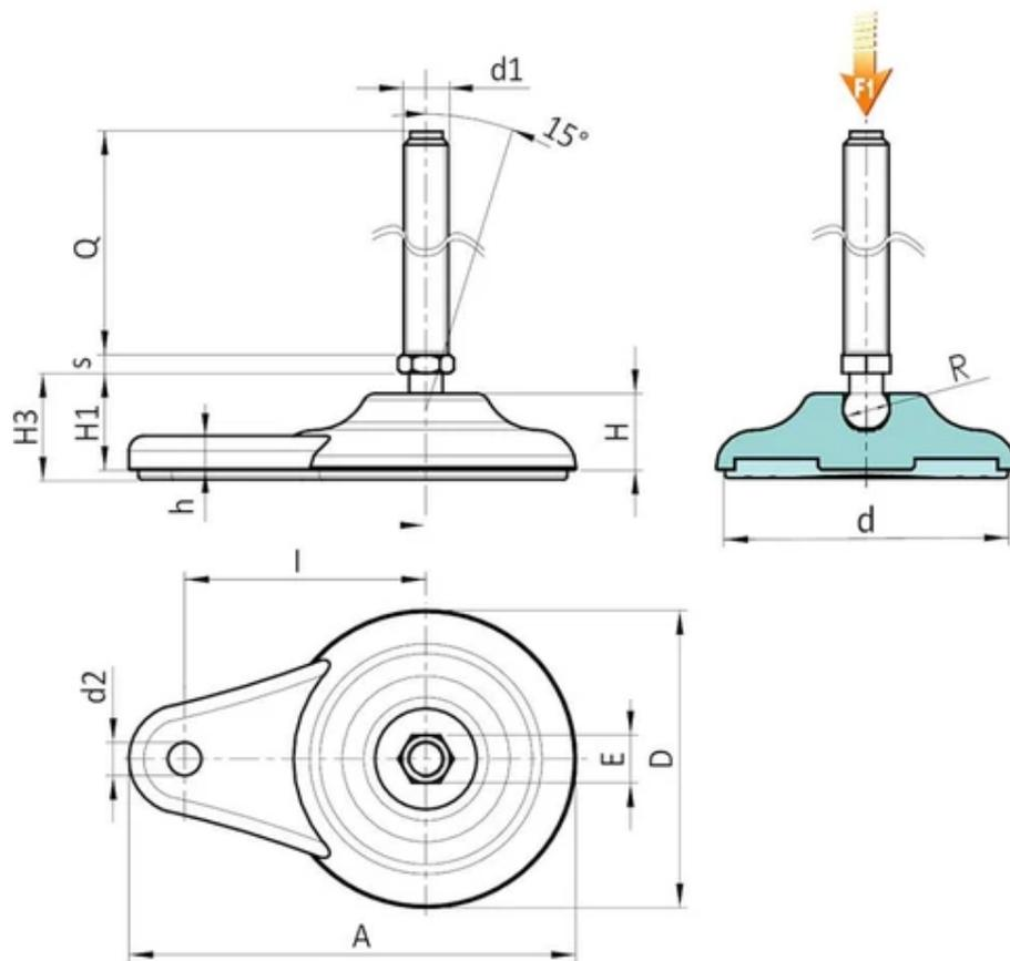
**Version P701 : Pied d'appui avec fixation latérale, tige de type A (avec hexagone) et bille 12,5 - avec base antidérapante en SBS**
