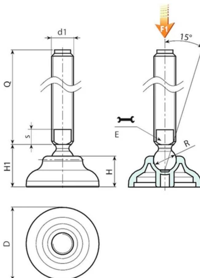
**Version P906 : Pied d'appui avec tige de type B (logement pour clé fraisé) et bille 12,4**
