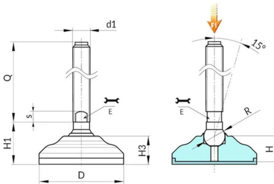
**Version P542 : Pied d'appui en acier zingué avec tige de type B (logement pour clé fraisé), bille 12,5 et base antidérapante en TPV**
