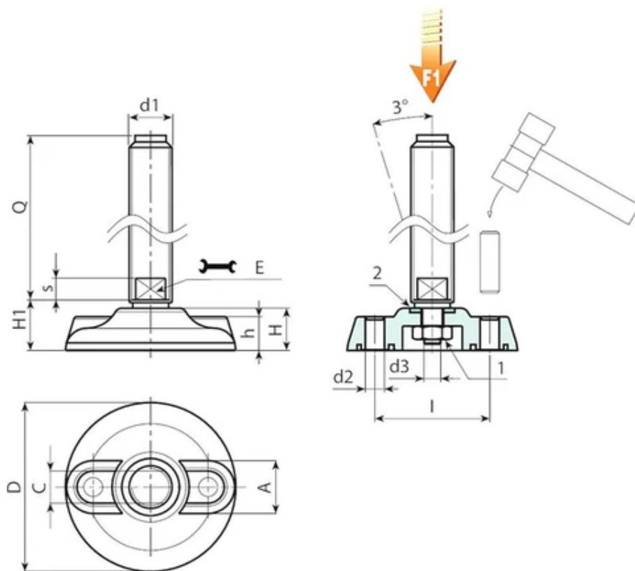
**Version P800 : Pied d'appui avec tige rotative et fixation par écrou**
