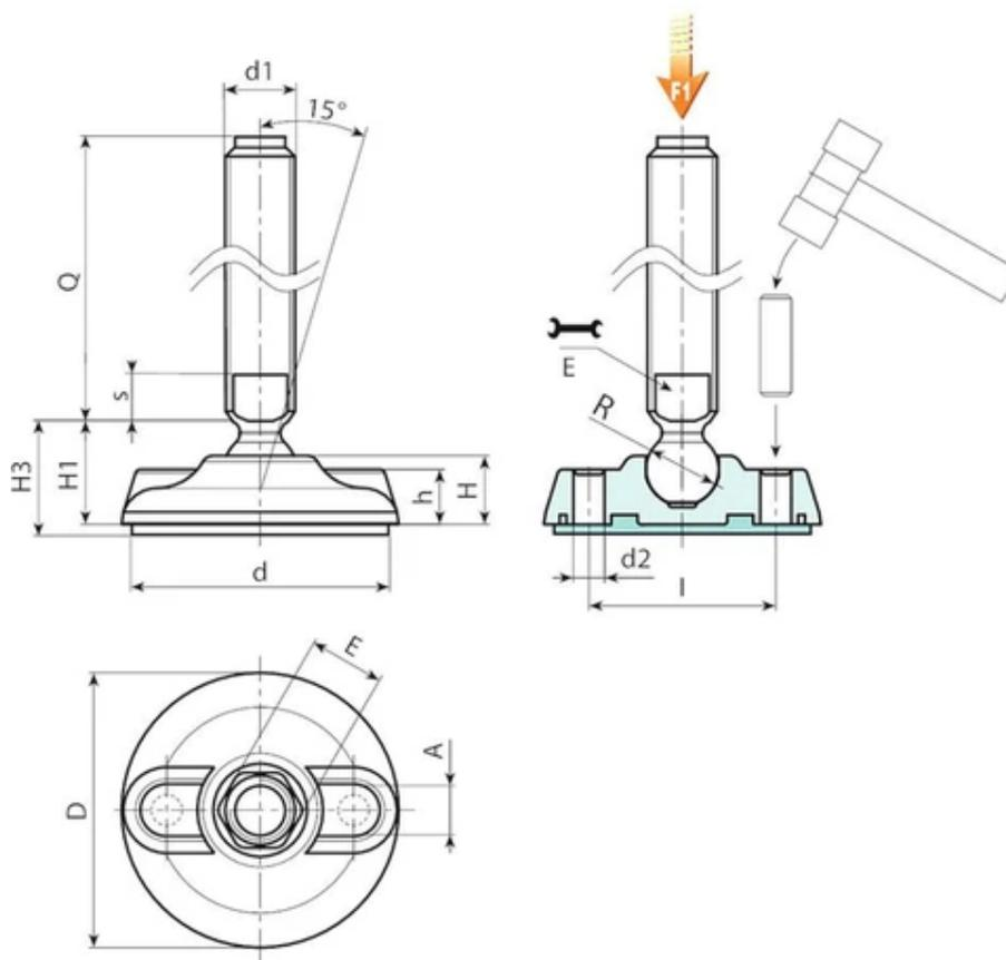
**Version P916 : Pied d'appui avec tige de type B (logement pour clé fraisé) et bille 12,4 avec base antidérapante en SBS**
