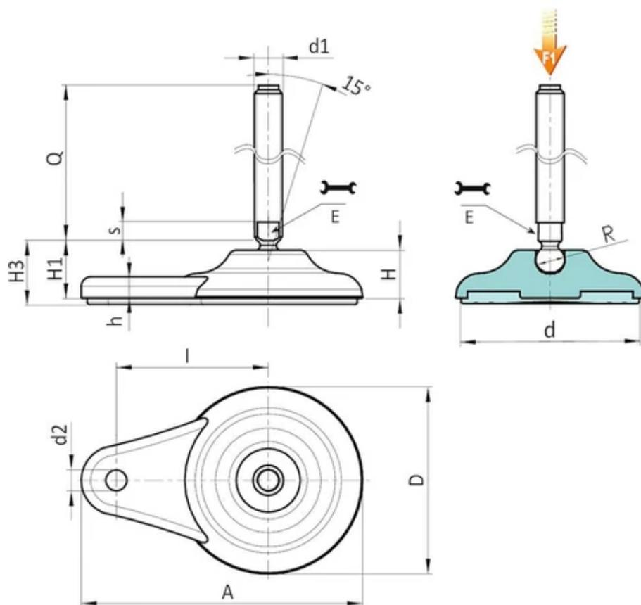
**Version P707 : Pied d'appui avec fixation latérale, tige de type B (logement pour clé fraisé), bille 15 et base antidérapante en SBS**
