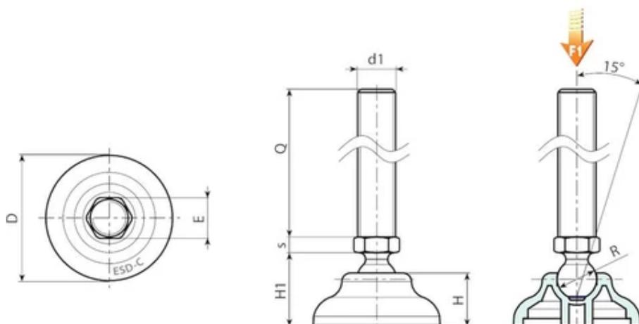
**Version P900ESD : Pied d'appui avec tige de type A (avec hexagone) et bille 12.4**
