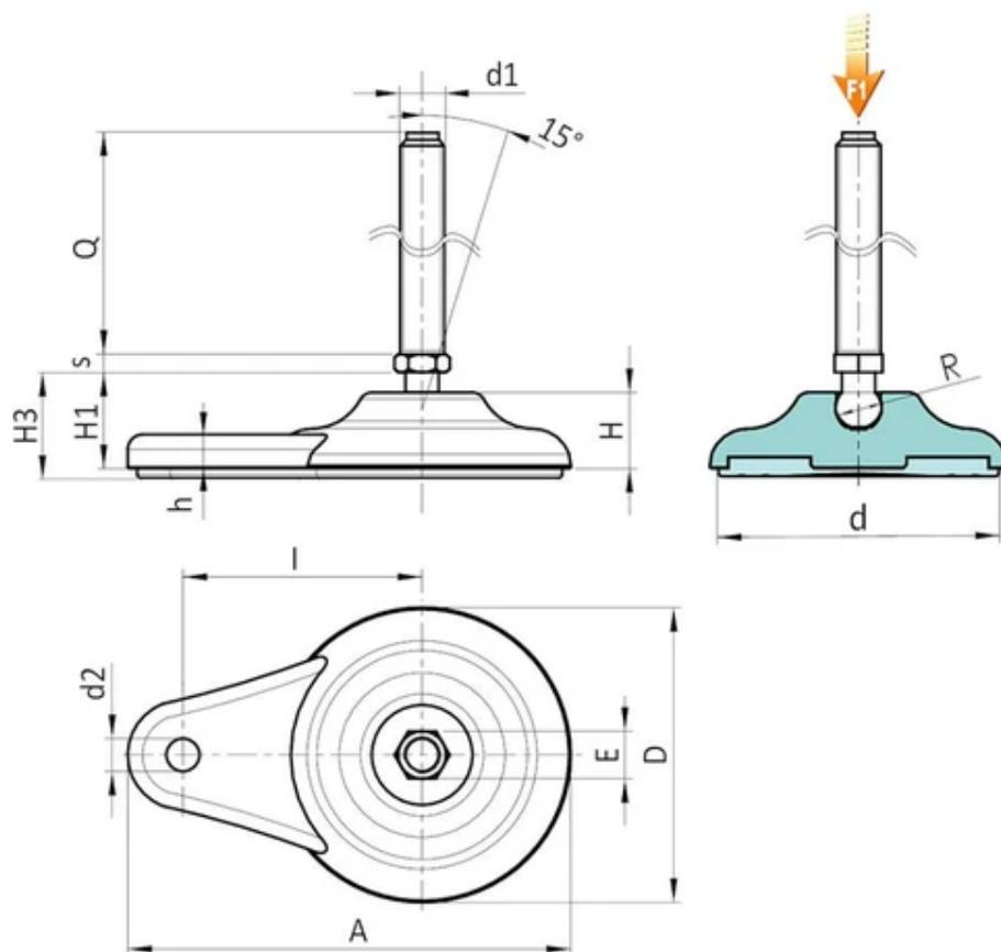
**Version P703 : Pied d'appui avec fixation latérale, tige de type A (base hexagonale), bille 15 et base antidérapante en SBS**
