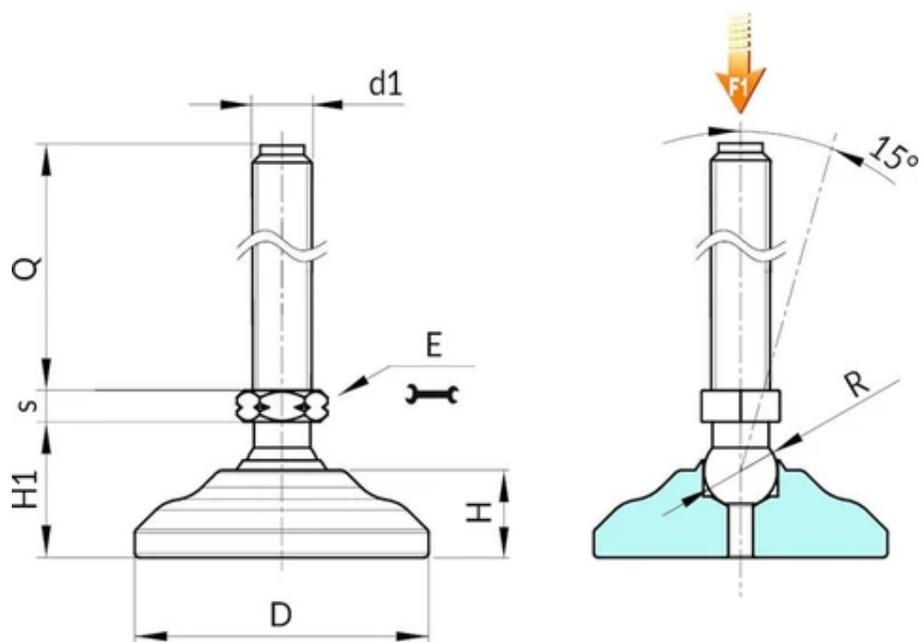
**Version P530 : Pied d'appui en acier zingué, tige de type A (avec hexagone) et bille 12,5**
