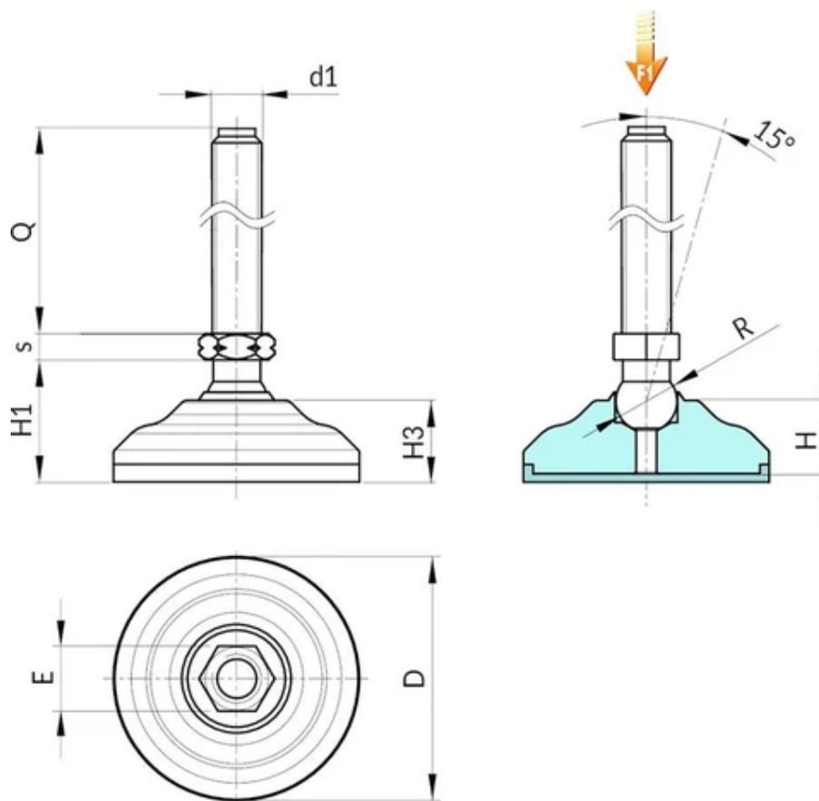
**Version P544 : Pied d'appui en acier zingué, tige de type A (avec hexagone), bille 24 et base antidérapante en TPV**
