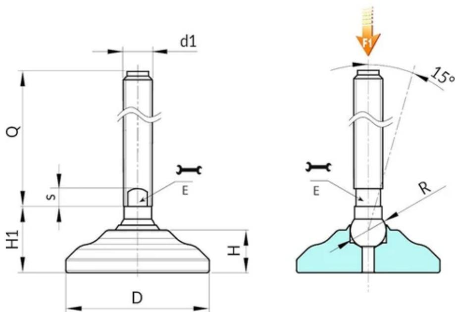
**Version P533: Pied d'appui en acier zingué avec tige de type B (logement pour clé fraisée) et bille 15**
