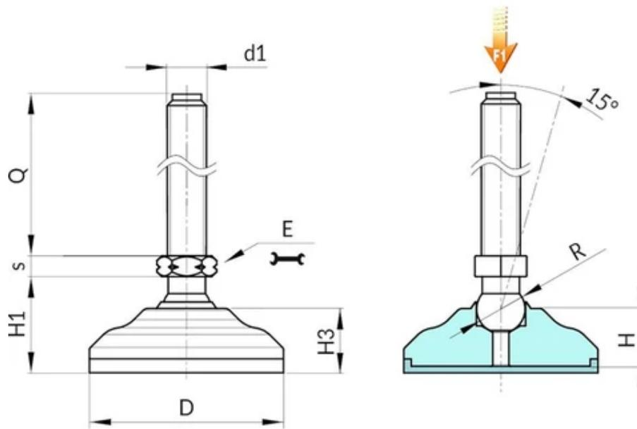
**Version P540 : Pied d'appui en acier zingué, tige de type A (avec hexagone), bille 12,5 et base antidérapante en TPV**
