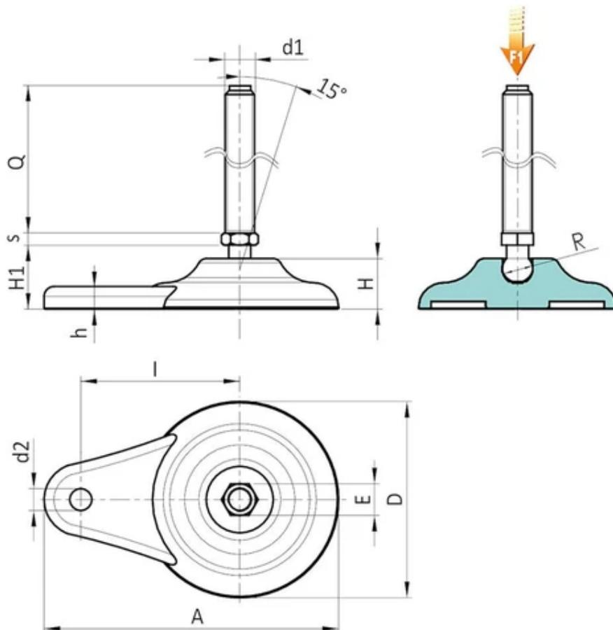
**Version P700 : Pied d'appui avec fixation latérale, tige de type A (avec hexagone) et bille 12,5**
