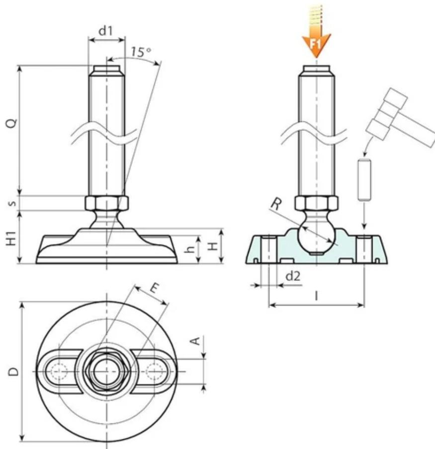
**Version P911 : Pied d'appui avec tige de type A (avec hexagone) et bille 12,4**
