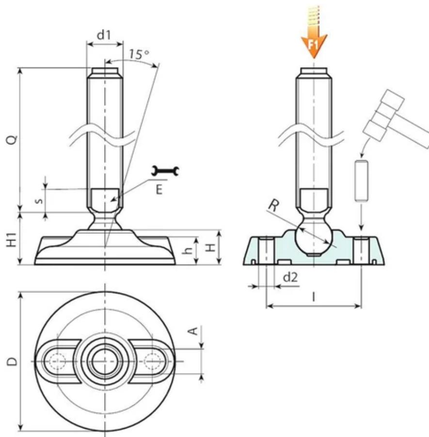
**Version P912 : Pied d'appui avec tige de type B (logement pour clé fraisé) et bille 12,4**
