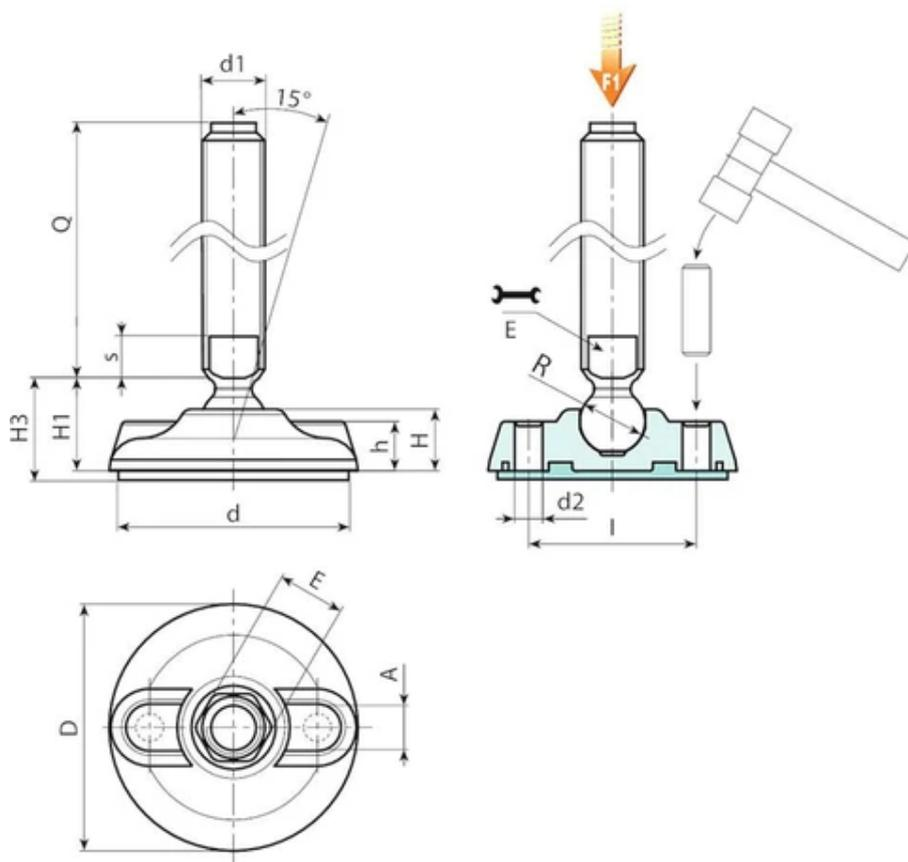
**Version P918 : Pied d'appui avec tige de type B (logement pour clé fraisé), bille 24 et base antidérapante en SBS**
