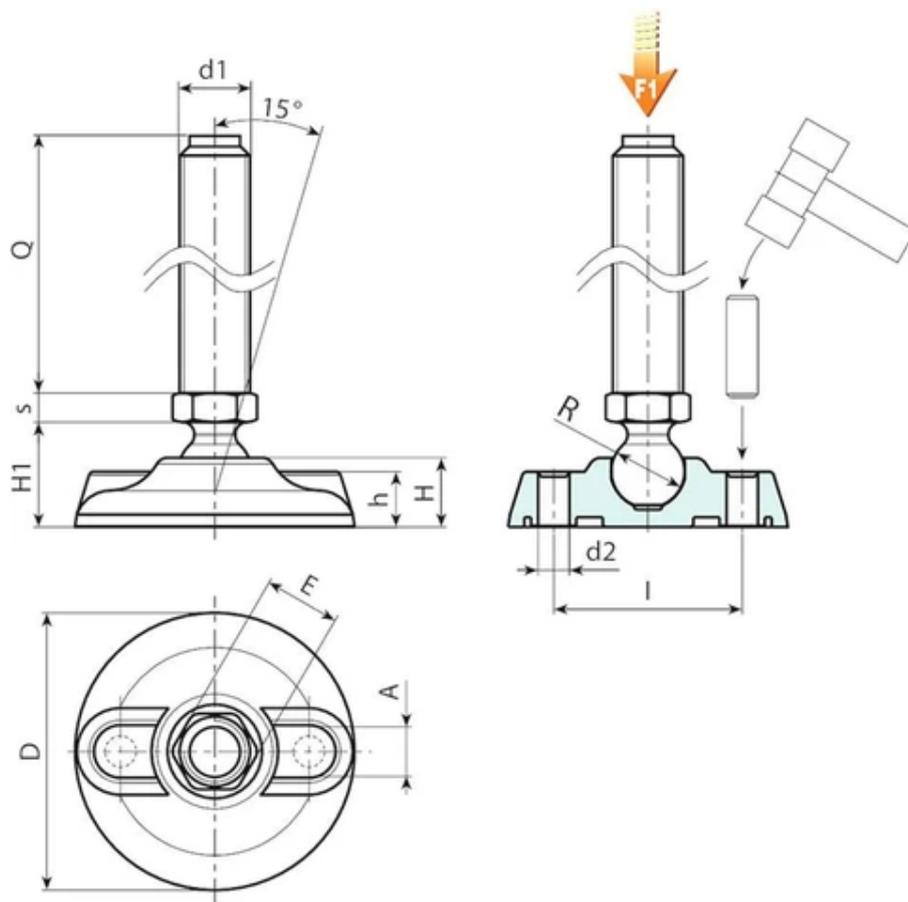
**Version P902 : Pied d'appui avec tige de type A (avec hexagone) et bille 15**
