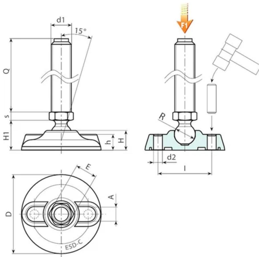
**Version P902ESD : Pied d'appui avec tige de type A (avec hexagone) et bille 15**
