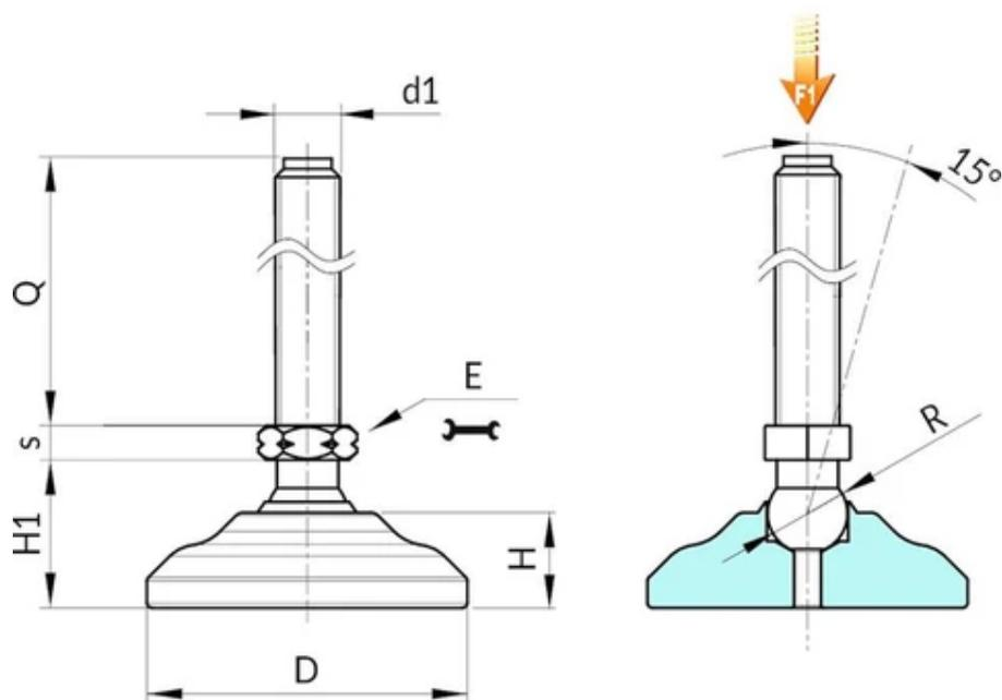
**Version P531: Pied d'appui en acier zingué, tige de type A (avec hexagone) et bille 15**
