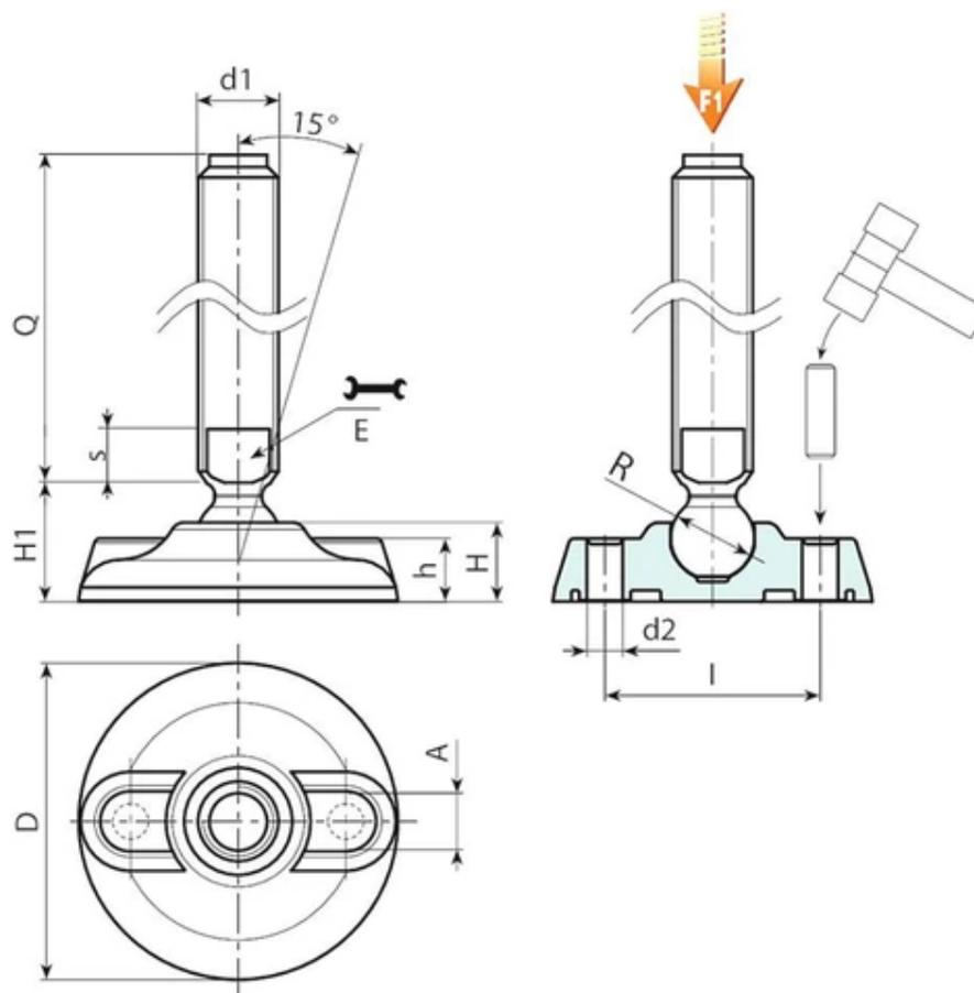
**Version P913 : Pied d'appui avec tige de type B (logement pour clé fraisé) et bille 15**
