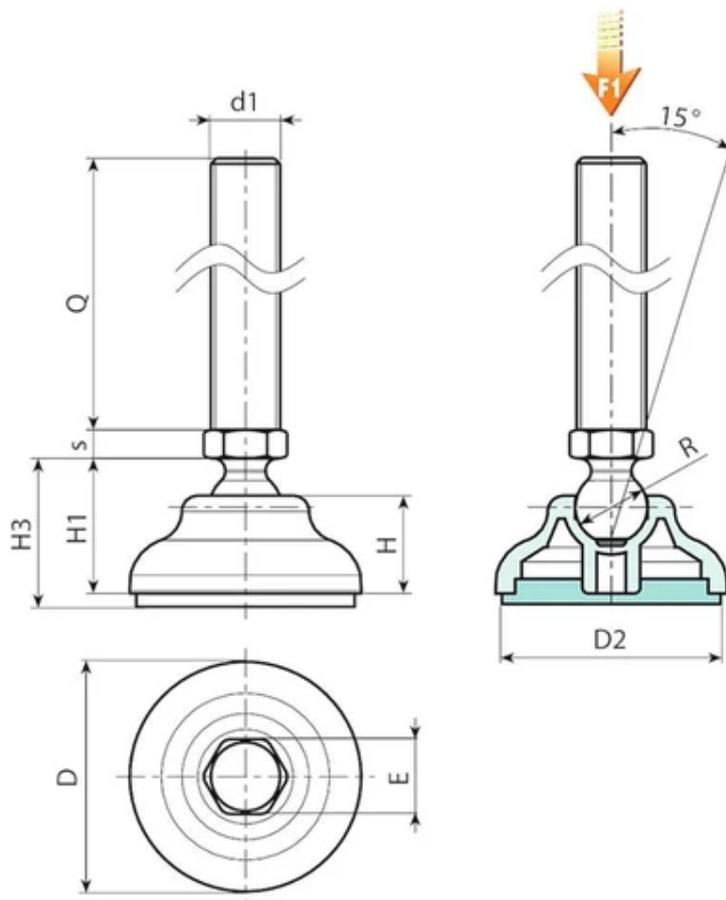
**Version P901 : Pied d'appui avec tige de type A (base hexagonale) et bille 12,4 avec base antidérapante en SBS**
