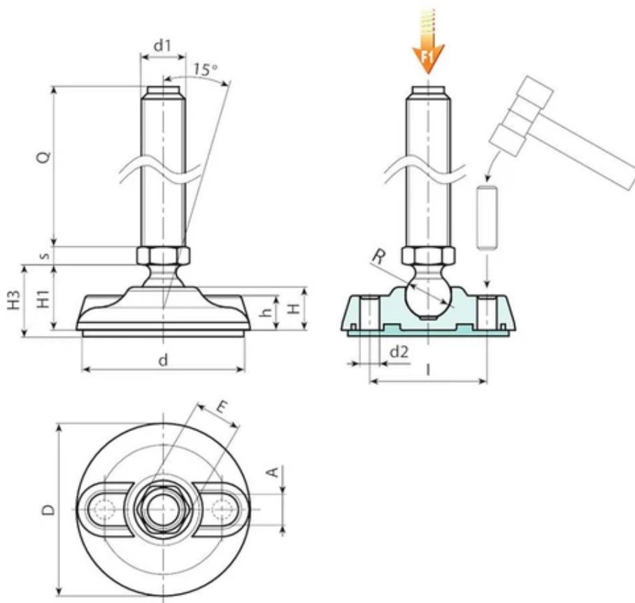
**Version P915 : Pied d'appui avec tige de type A (avec hexagone), bille 12,4 et base antidérapante en SBS**
