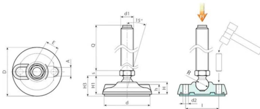
**Version P903 : Pied d'appui avec tige de type A (base hexagonale) et bille 15 avec base antidérapante en SBS**
