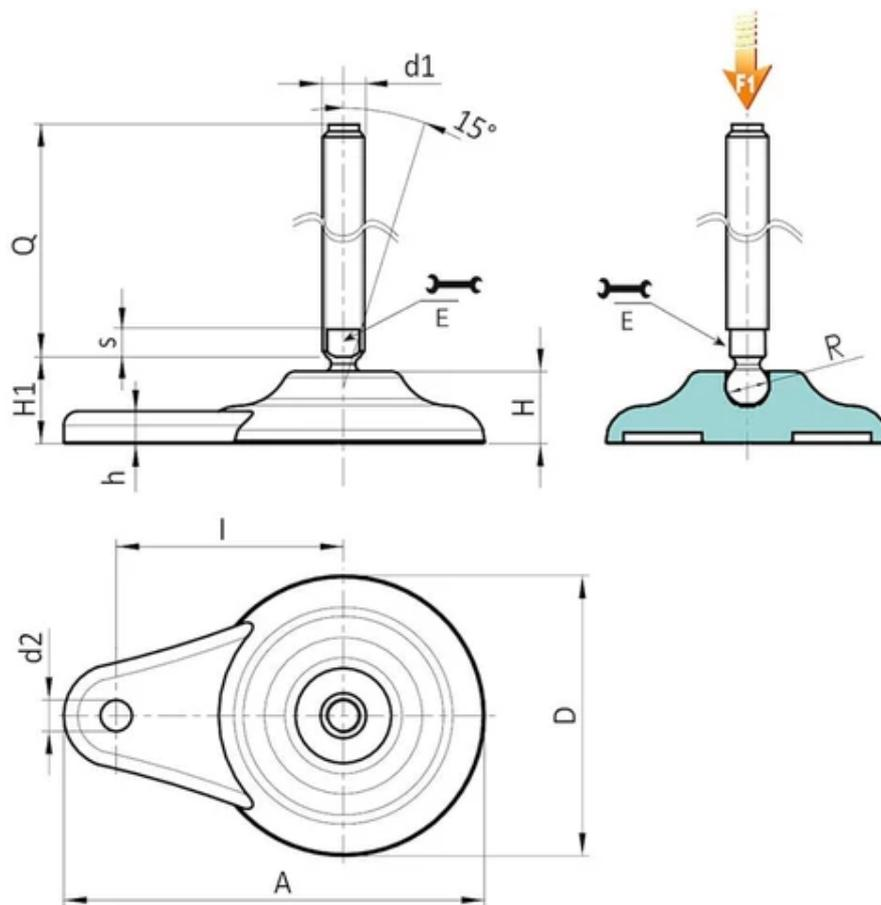
**Version P708 : Pied d'appui avec fixation latérale, tige de type B (logement pour clé fraisé) et bille 24**
