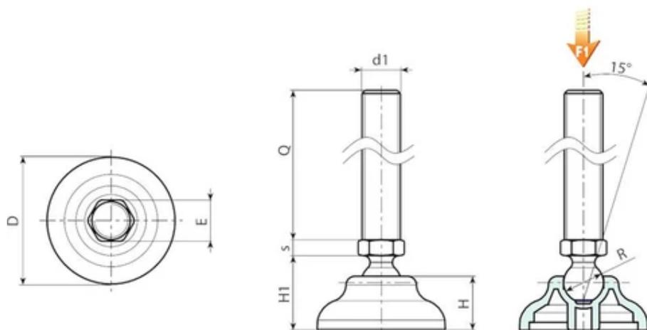
**Version P900 : Pied d'appui avec tige de type A (avec hexagone) et bille 12,4**
