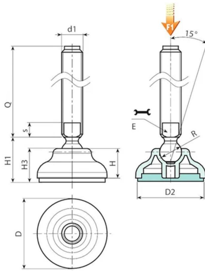
**Version P910 : Pied d'appui avec tige de type B (logement pour clé fraisé) et bille 15 avec base antidérapante en SBS**
