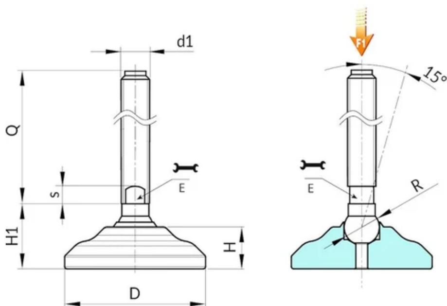
**Version P532 : Pied d'appui en acier zingué avec tige de type B (logement pour clé fraisé) et bille 12,5**
