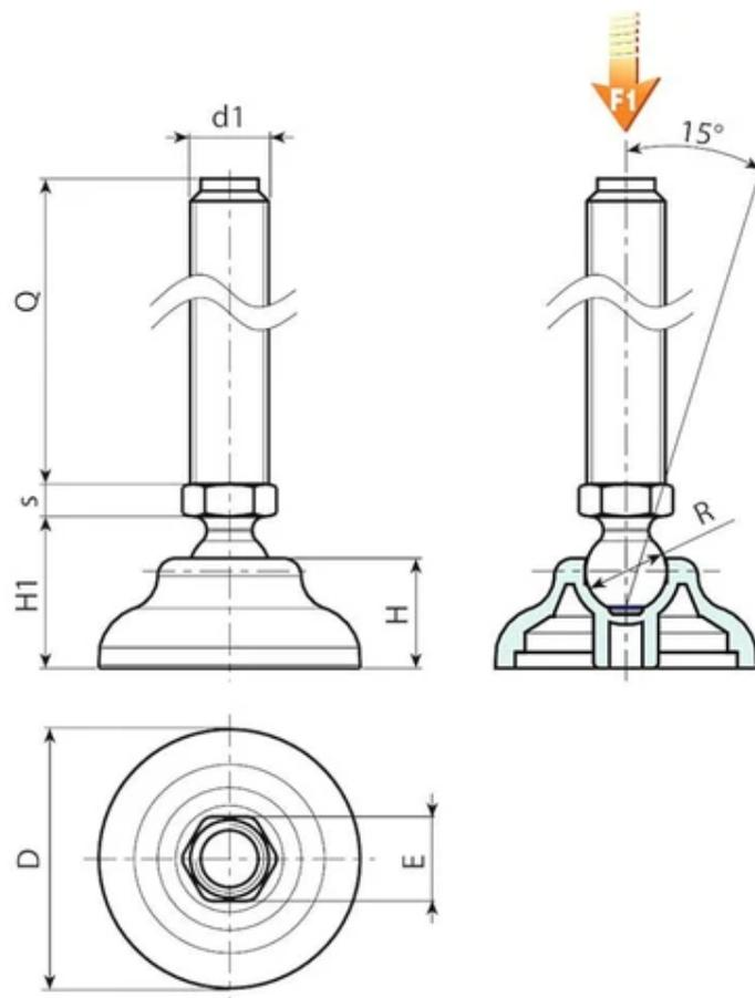
**Version P905 : Pied d'appui avec tige de type A (avec hexagone) et bille 15**
