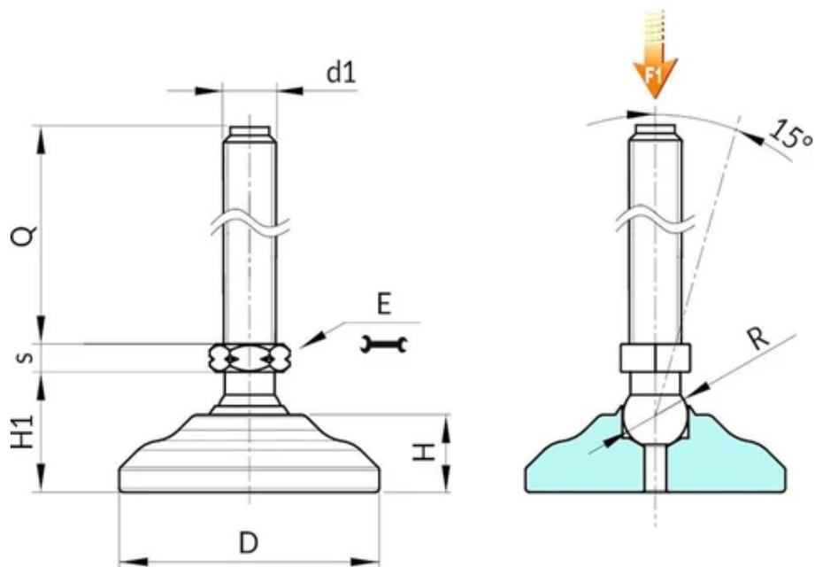
**Version P534 : Pied d'appui en acier zingué, tige de type A (avec hexagone) et bille 24**
