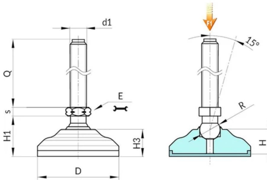
**Version P541 : Pied d'appui en acier zingué, tige de type A (avec hexagone), bille 15 et base antidérapante en TPV**
