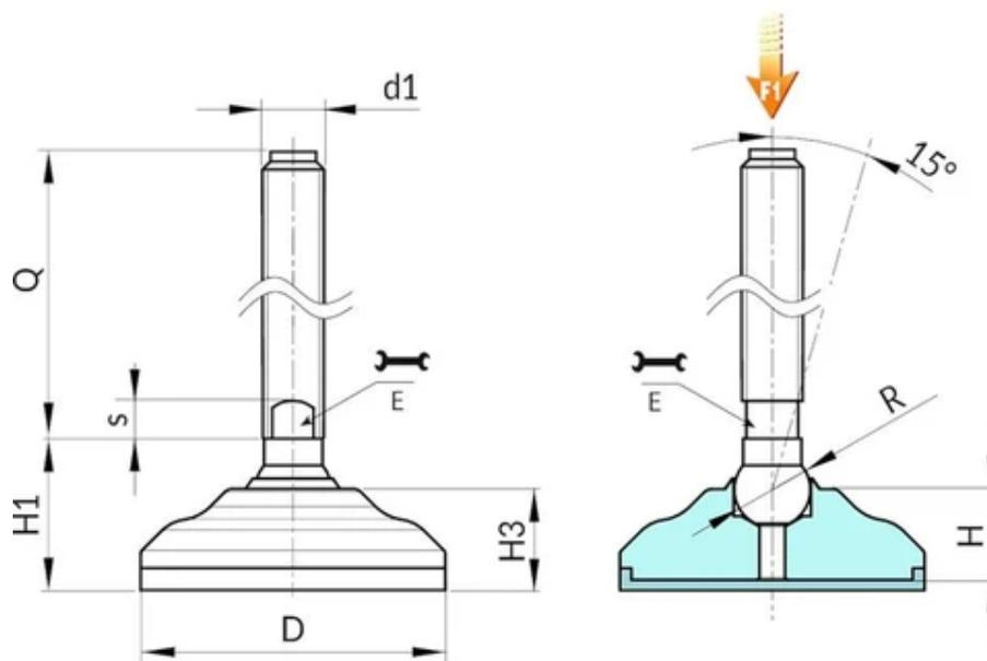
**Version P543 : Pied d'appui en acier zingué avec tige de type B (logement pour clé fraisé), bille 15 et base antidérapante en TPV**
