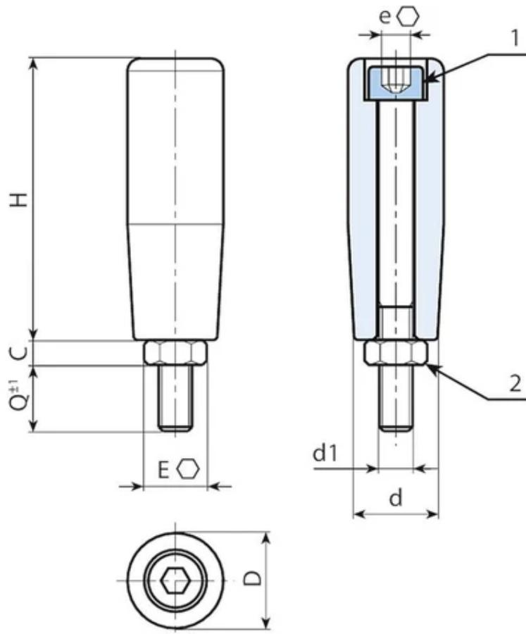
**Ausführung M144: mit Einsätzen aus brüniertem Stahl.**
