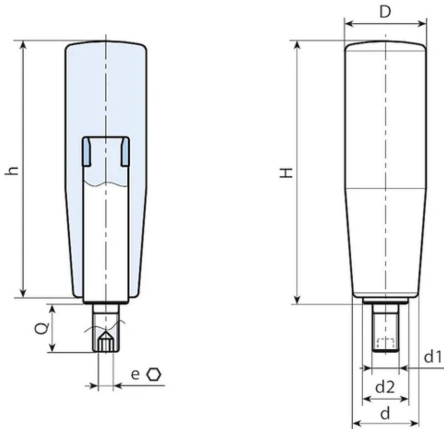
**Ausführung M129: mit Einsatz aus verzinktem Stahl.**
