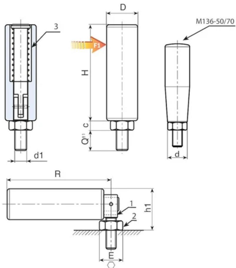
**Ausführung M136: Ausführung aus brüniertem Stahl.**
