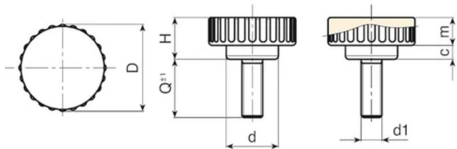
**Ausführung H171CON: Mit Buchse aus Messing.**
