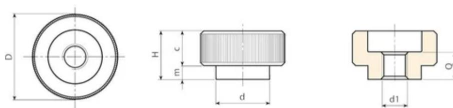
**Ausführung Y303: aus brüniertem Stahl**
