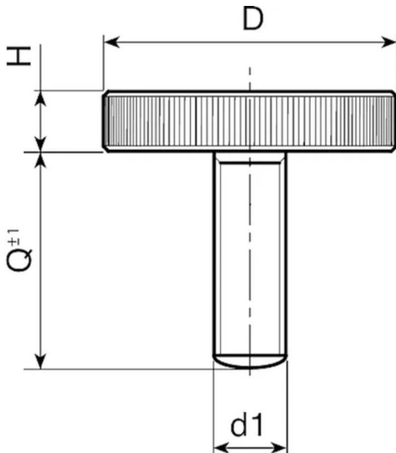
**Ausführung Y653: aus brüniertem Stahl**
