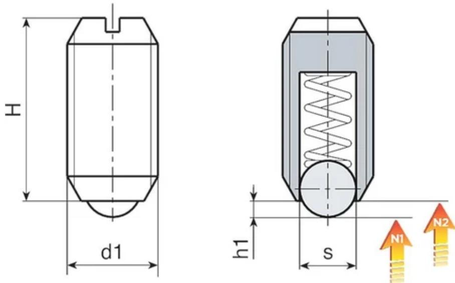
**Ausführung W838: mit Kugel aus Kunststoff (DELRIN)**
